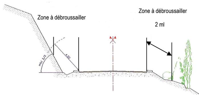
Cas des routes avec obstacles physiques à moins de 2m de part ou d'autre de la chaussée (murs, parapets, falaises, rochers...) : débroussaillage de part et d'autre de la chaussée jusqu'aux obstacles limitant l'intervention d'une épareuse.
